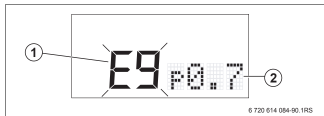
Fig. 75 Mesaje de defecțiune pe display
