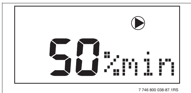
Fig. 49 Mesaje de display „Modulația pompelor“
